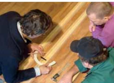
*Aus einem Wacholderstamm wird ein Hirtenhorn: Der Stamm wird der Länge nach durchgesägt; auf der Innenseite wird die Vorlage aufgezeichnet (oben), die Hälften werden mit dem Stecheisen konisch ausgehöhlt (oben rechts). Danach wird das Äußere abgerundet, das heißt, die Rinde wird entfernt und der Rest wird abgehobelt, sodass außen eine halbrunde Form entsteht (rechts).*
