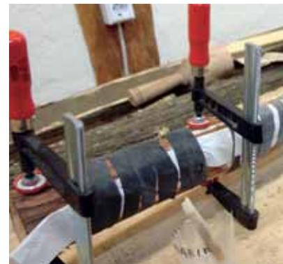
Die Halbschalen werden verzapft (oben) und zur Probe aufeinandergesetzt. Anschließend wird der Leim aufgetragen (oben Mitte). Beim Zusammensetzen der Halbschalen packen viele Hände mit an (oben), ebenso beim Umwickeln mit aufgeschnittenen Fahrradschläuchen. Dann sehen die Hirtenhörner aus wie bandagiert (oben rechts) und trocknen über Nacht. Der erste Ton am nächsten Morgen wird mit Spannung erwartet (rechts).
